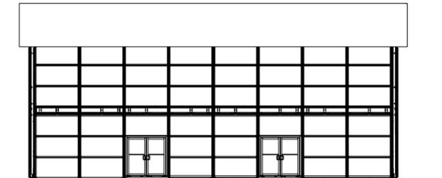
■ Pórtico frontal con paneles de cristal horizontales o paneles térmicos
